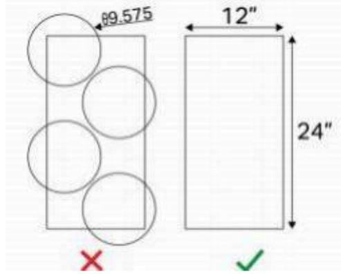
图 R17-1：自制塑料件须可容纳于单块 12" x24" 的塑料板内
