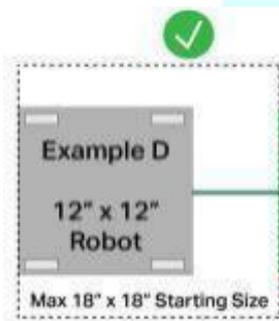
图 SG2-4：合规。起始尺寸小于18"x18"的机器人仍然可以在其选择的方向上扩展至24"
