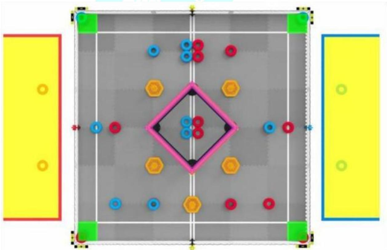
图 FO-1：场地初始布局俯视图，高亮标示移动桩（橙色），联队站位区（黄色），区（绿色）及高塔（粉色）
