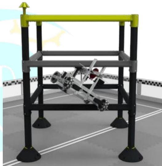
图 SC7-2：机器人仍接触第一条高塔横杆，因此，它处于第一层攀爬
